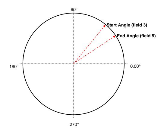
FIGURE 6: LOCATION OF A SIDE DRILLING FEATURE (START ANGLE, END ANGLE)
