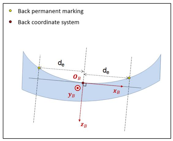
FIGURE 2: BACK ENGRAVINGS REFERENCE COORDINATE SYSTEM
