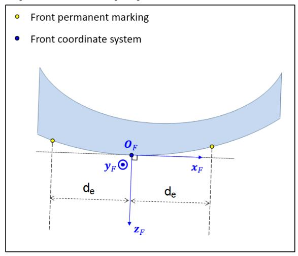
FIGURE 1: FRONT ENGRAVINGS REFERENCE COORDINATE SYSTEM
