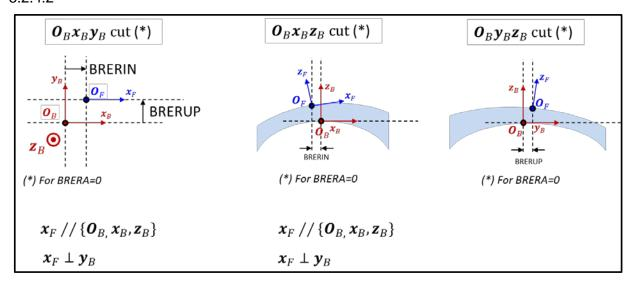
FIGURE 3: DEFINITION OF THE LENS REFERENCE COORDINATE SYSTEM ON THE FRONT  $(O_Fx_Fy_Fz_F)$  ACCORDING TO THE REFERENCE COORDINATE SYSTEM ON THE BACK  $(O_Bx_By_Bz_B)$
