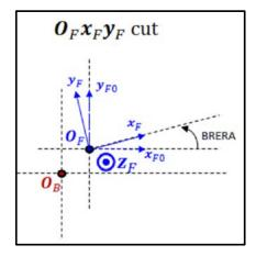
FIGURE 4: TRANSFER FROM THE LENS REFERENCE COORDINATE SYSTEM ON THE BACK  $(O_B x_B y_B z_B)$  TO THE REFERENCE COORDINATE SYSTEM ON THE FRONT  $(O_F x_F y_F z_F)$
