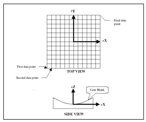
FIGURE 10: SURFACE MATRIX ORIENTATION
